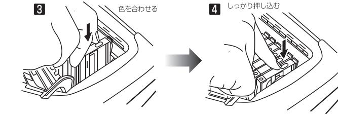
！ このインクカートリッジは他の挿入箇所にもセットできてしまうため、挿入箇所をよく確認して間違いのないようにセットしてください。万一、間違えてセットすると、プリンタがカートリッジを認識しない、印刷色がおかしい等のトラブルの原因となります。
