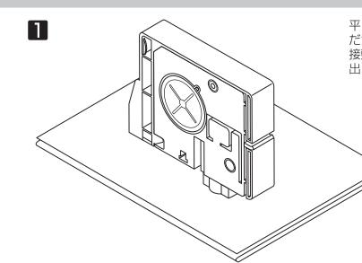
平らな面上にインクカートリッジを置いてください。インク出口内部のフィルターに直接触れる場合は、漏れ出る可能性があります。
