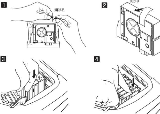
このインクカートリッジは他色の挿入箇所にもセットできてしまうため、挿入箇所をよく確認して間違いのないようにセットしてください。万一、間違えてセットすると、プリンタがカートリッジを認識しない、印刷色がおかしい等のトラブルの原因となります。
