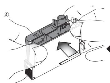
図の様にエコカートリッジケースのピンをインクタンクの穴に押し込んでください。
