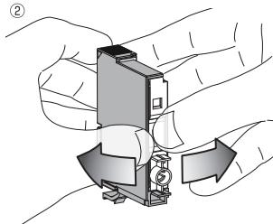
エコカートリッジケース、インクタンクの端を持ち、左右に開いて、になったインクタンクを取り外してください。
