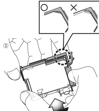
新しいインクタンクの上部がエコカートリッジケースにしっかりと入り込むように挿入してください。【点線箇所、正しく組み込まれているか、ご確認ください。】
