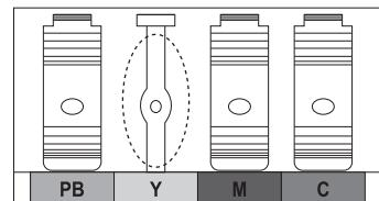
2、インクボトルの先端をインク注入口に差し込むと、インクの注入が始まります。注入を終えられましたら、インクボトルのキャップを閉めてください。
