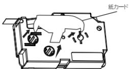
3、セットする前にラベルを3センチぐらい引き出し、図のように製品正面の穴部分を軽く回転させてください。
