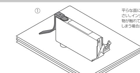
平らな面にインクカートリッジを置いてください。インク出口内部のフィルターに直接敷物が触れていると過剰にインクを吸い出してしまう場合があります。
