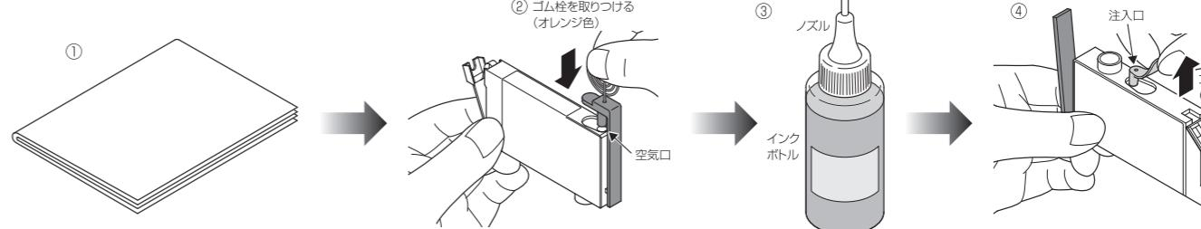
④インクカートリッジの注入口に取り付けられているゴム栓（インク同色）を取り外します。
