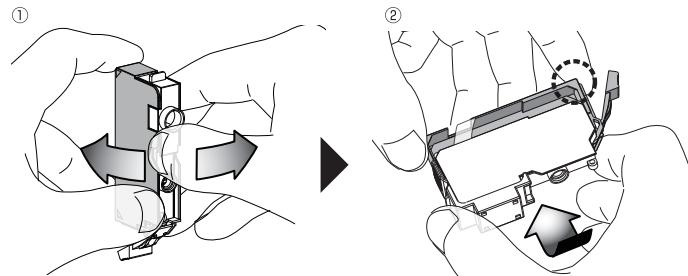
エコカートリッジケース、インクタンクの端を持ち、左右に開いて、になったインクタンクを取り外してください。
