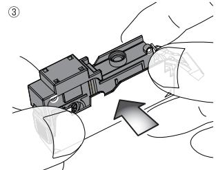
図の様にエコカートリッジケースのピンをインクタンクの穴に押し込んでください。
