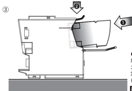
①エコカートリッジケースを動かさず、新しいインクタンクを挿し込み、②エコカートリッジケースにインクタンクが固定されたことを確認してください。(インクタンクの向き、ご注意ください。)
