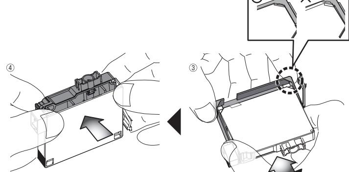
図の様にエコカートリッジケースのピンをインクタンクの穴に押し込んでください。
