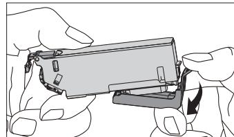
3. インクカートリッジのラベル色とプリンターの挿入箇所の色を合わせ、セットしてください。
